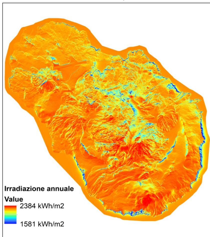
Figura 7 - Mappa di radiazione solare su Pantelleria (radiazione relativa al piano inclinato e orientato secondo l'orografia)
