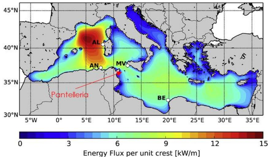
Figura 10 - Flusso di energia medio annuale per unità di lunghezza del fronte d'onda nel Mar Mediterraneo [7]
